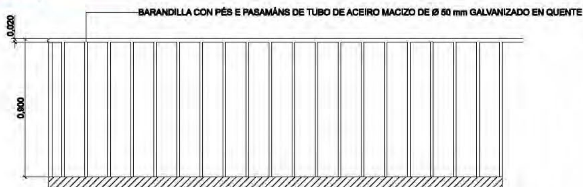
DETALLE BARANDILLA TIPO: (COTAS EN m)
